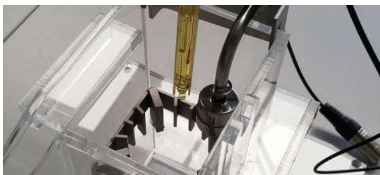
left: optional pH meter ; right: optional level indicator.
